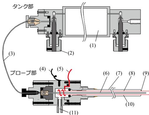
図 1：プローブの概略図
